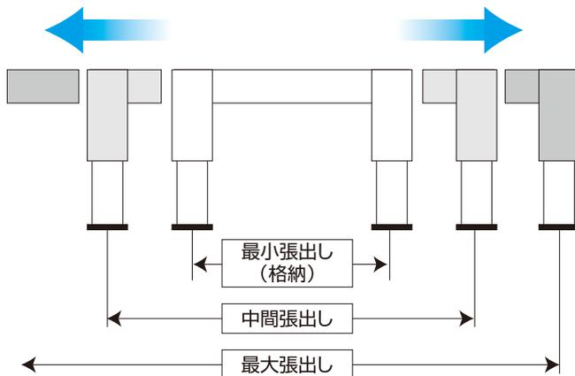
アウトリガの張出し幅は広いほど安定感が高く、狭くなると安定度は低下します。空車時定格総荷重の性能はキャブバック架装時のアウトリガを最大に張出した時の後方・側方吊りの値です。中間張出し・最小張出し状態では性能がこれより低下します。
